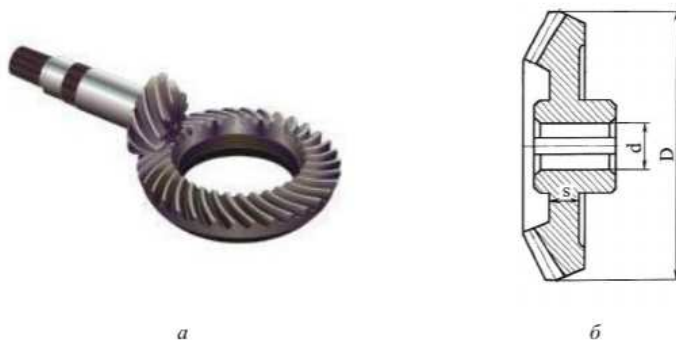
Рис. 1.1. Зубчатое колесо редуктора ручной строительной лебедки:
