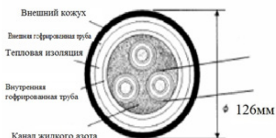
Рисунок 1. Конструкция 3-фазного ВТСП кабеля
