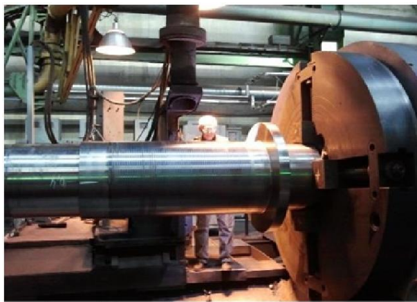
Процесс струйной плазменной закалки шпинделя в цехе 66 ОМЗ «Спецсталь». Полное время обработки составило 4ч 18 мин.
