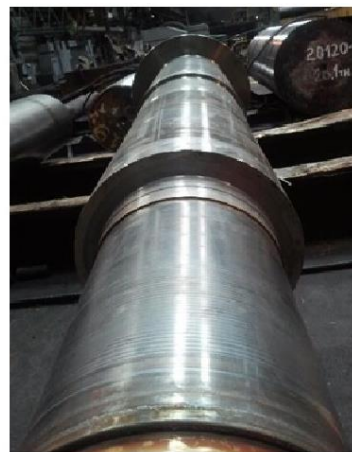
Полностью термобработанный шпиндель перед шлифовкой
